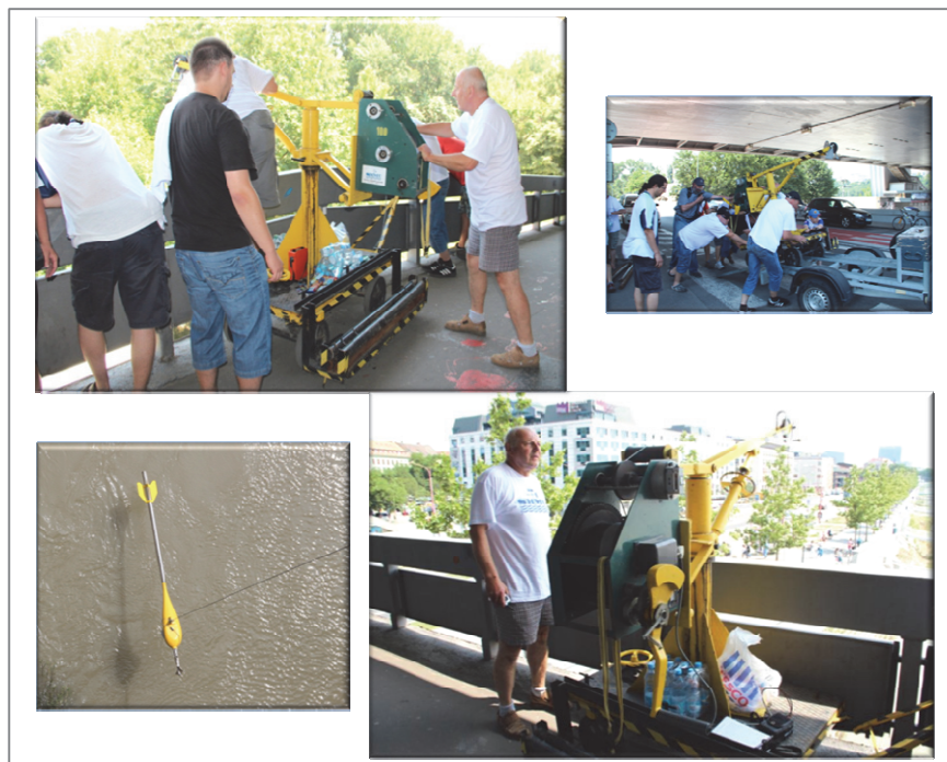
Obr. 1. Vozík s hydrometrickým krídlom na závese, so 100 kg torpedu.
