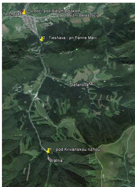
Obr. 5. Vybrané priečne profily na určenie kulminačného prietoku Varínky vo Vrátnej doline
