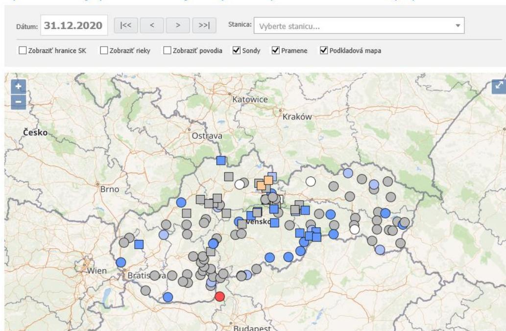
Hladina podzemnej vody a teplota, resp. výdatnosť prameňa a teplota, boli na online pozorovacích staniach merané v hodinovom intervale a okamžite prenášané, vyhodnocované a zobrazované na web stránkach SHMÚ. Namerané a vyhodnotenú údaje z operatívneho monitoringu podzemných vôd sú priebežne voľne dostupné na - [http://www.shmu.sk/sk/?page=1&id=pzv\\_kvantita](http://www.shmu.sk/sk/?page=1&id=pzv_kvantita).
