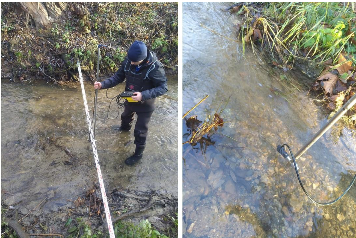
Obrázok 9. Hydrometrovanie – meranie bodových rýchlostí za pomoci prístroja Flo – Mate 2000
