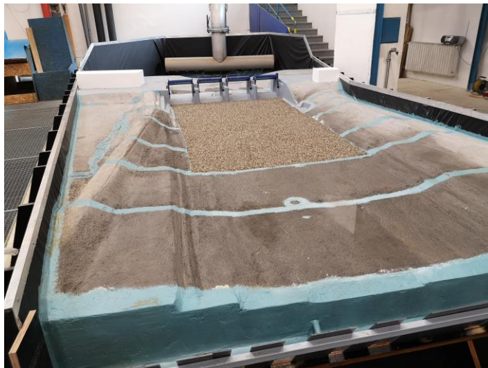
Obrázok 2: Fyzikálny trojrozmerný model VD Hričov
