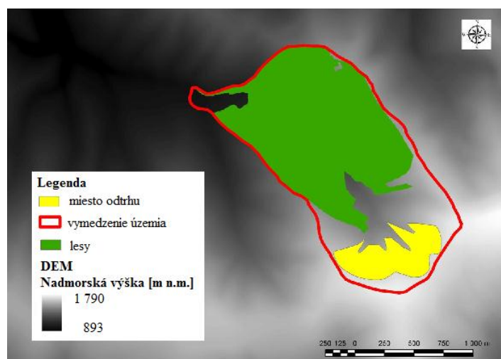
Obr. 3 Zobrazenie vstupných údajov pre simuláciu lavíny v súčasnosti Input data of avalanche simulation at present
