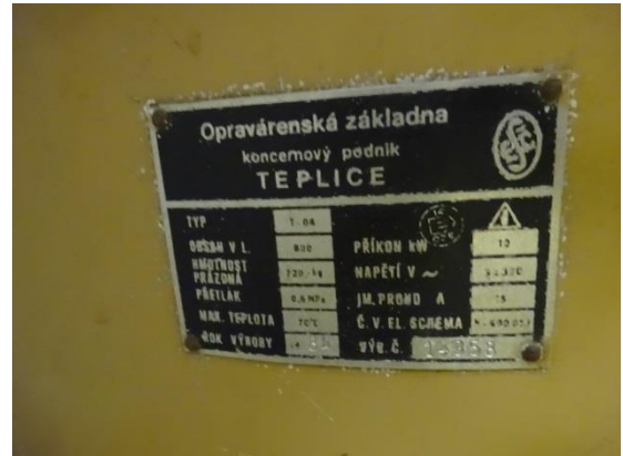
Obrázok 9 – Štítkový údaj zariadenia zásobníka
