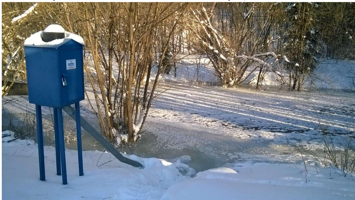
Obr. 11 Vzduťie vodnej hladiny ovplyvnenej ľadovými úkazmi vo vodomernom profile Čierny Váh na Čiernom Váhu, 9.1.2017 (foto: Dunajská)
