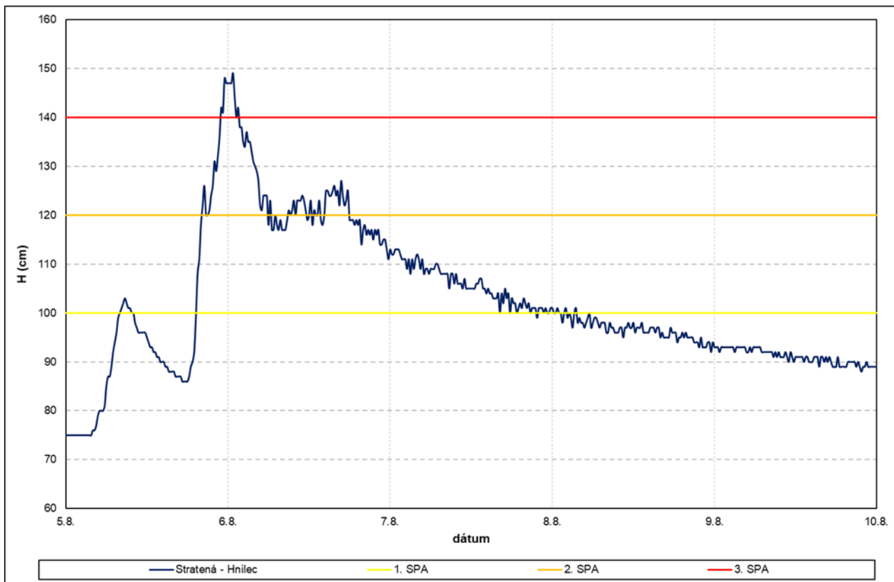
Obr. 3.4 Priebek vodnej hladiny vo vodomernej stanici Stratená na toku Hnilec, august 2023
