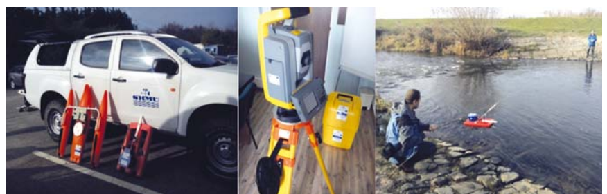
Obr. 2 Terénny automobil s prístrojmi na meranie prietokov. Nivelačný prístroj. Meranie prietoku na Iplí.
