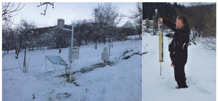
Obr. 1 Automatická zrážkomerná stanica v Perneku. Set na meranie výšky snehovej pokrývky a vodnej hodnoty snehu.
