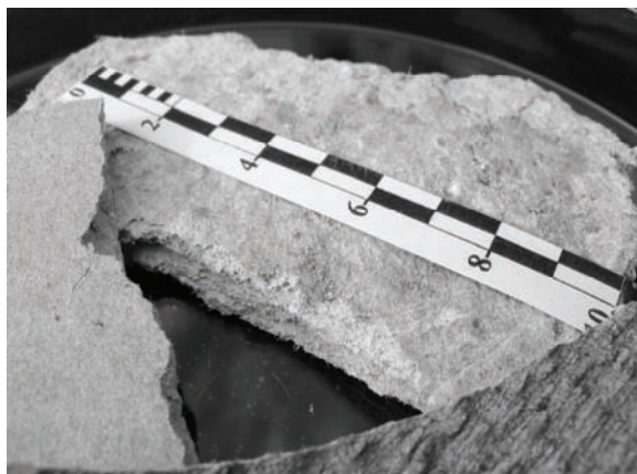
Obrázok 3b. Zrnitostná trieda 0,5–1,0 mm z meliva vzorky strešnej eternitovej krytiny E. Figure 3b. The grain-size 0,5–1,0 mm in the pulverized sample of the eternit roof covering E.
