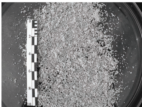
Obrázok 3b. Zrnitostná trieda 0,5–1,0 mm z meliva vzorky strešnej eternitovej krytiny E. Figure 3b. The grain-size 0,5–1,0 mm in the pulverized sample of the eternit roof covering E.
