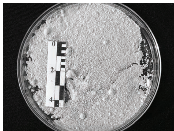
Obrázok 3d. Vzorka filtračného koláča po karbonatizácii CO 2 termicky upravenej vzorky strešnej eternitovej krytiny. Figure 3d. Sample of the filtration cake after the CO 2 carbonization of thermally modified eternit roof covering sample.
