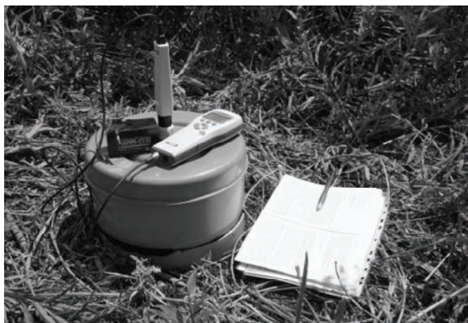
Obrázok 5. Uzatvorená komora počas merania pôdnej respirácie.
