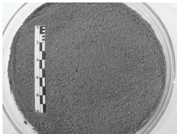
Obrázok 2c. Karbonátový produkt pripravený karbonatizačnou reakciou CO 2 a kryštalizáciou z filtrátu vzorky T.
